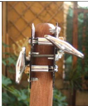
Ho stretto la flangia, l'ho bucata ed ora le meccaniche sono passanti e scaricano sulla flangia stessa la trazione.
